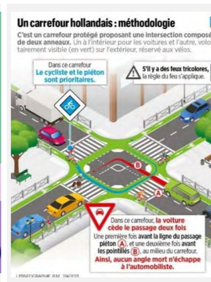
Infographie aménagement carrefour à la hollandaise (source : le Parisien)
